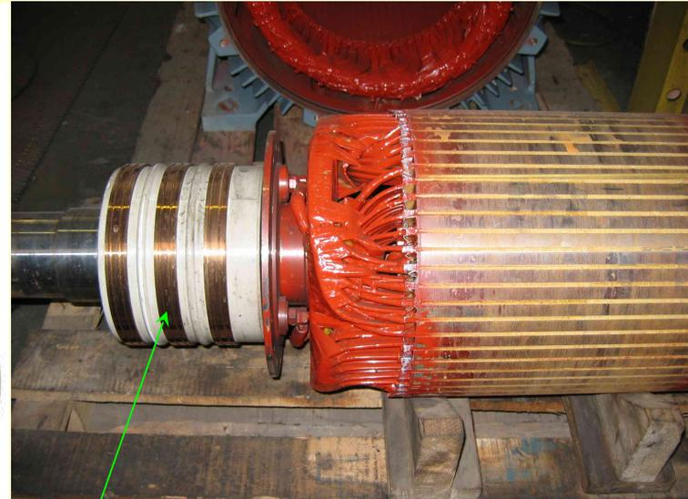
les 3 bagues d'un rotor bobiné
